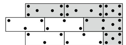
Bei Steinwolle-Dämmplatten – die graue Markierung zeigt den Randbereich für die Verdübelung bei starken Windlasten. Auch für Hochhäuser geeignet.
