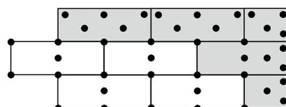
Bei EPS-Dämmplatten – die graue Markierung zeigt den Randbereich für die Verdübelung bei starken Windlasten. Bis 30 m.
